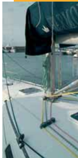
Sopra, la cima gialla è il paranco di scotta, come si vede è sdoppiato e può essere manovrato da entrambi i lati
