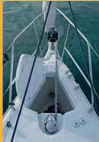
Sopra, il grande gavone delle ancore con il verricello verticale in grado di tirare indifferentemente la catena o la cima
