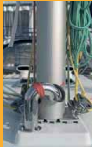
Sotto, il manicotto d'acciaio che protegge i cavi che escono dall'albero
